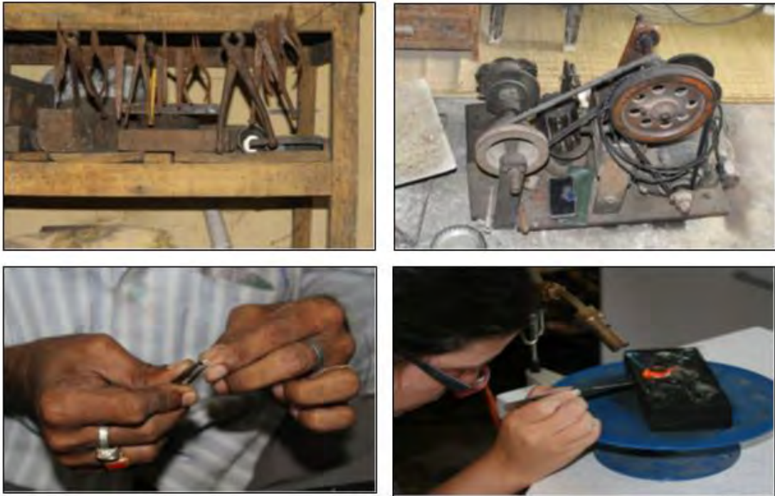
चित्र 1.2.5: ताराकासी ज्वैलर द्वारा इस्तेमाल किए जाने वाले सरौता, चिमटी, टांका लगाने के लिए टॉर्च
